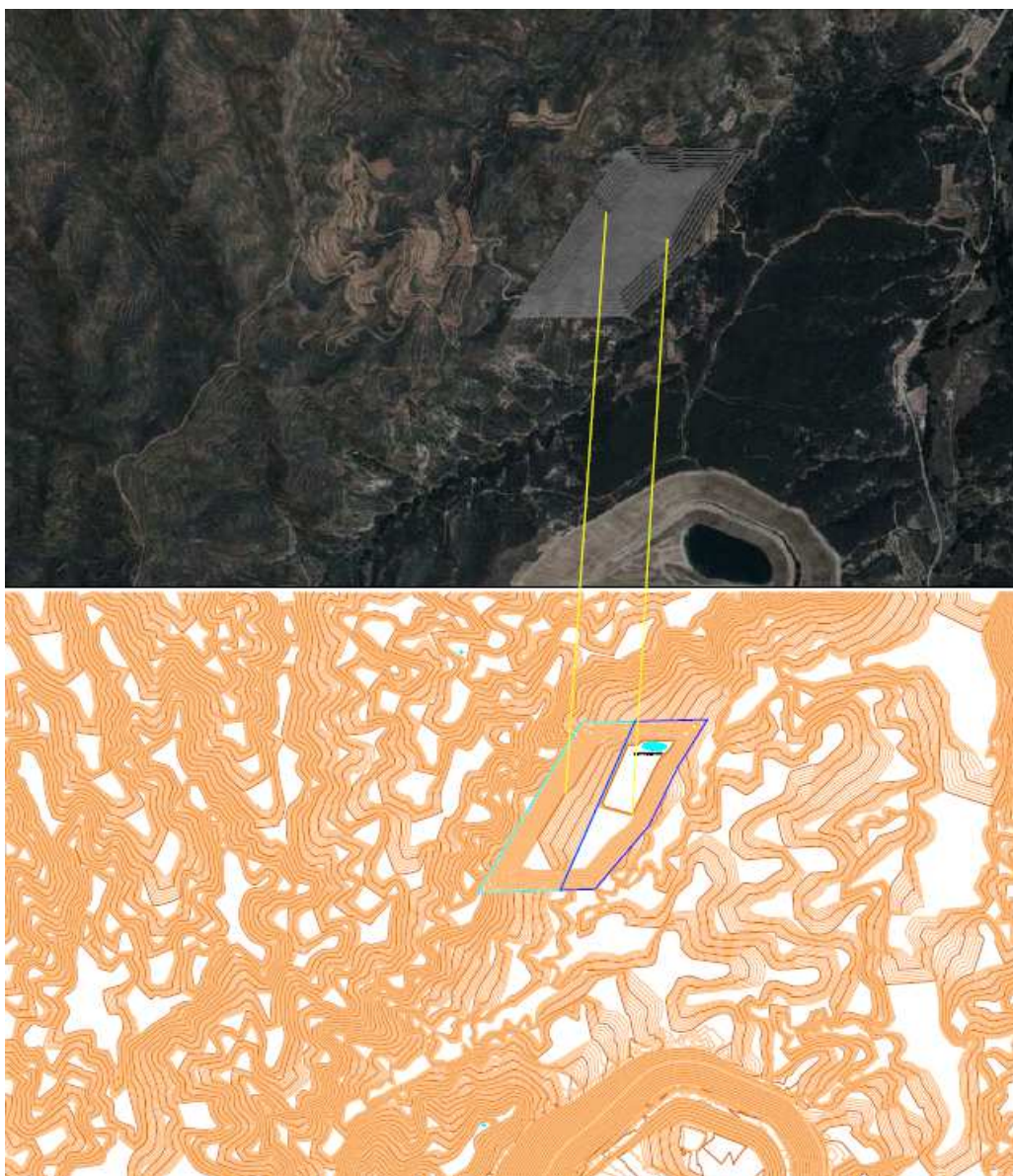
Figura 44. Simulación 3D y curvado de situación del hueco teórico de explotación tras la explotación de la Fase II (en azul) y de la Fase I (en cian) y sus correspondencias mediante líneas en amarillo con la simulación.
