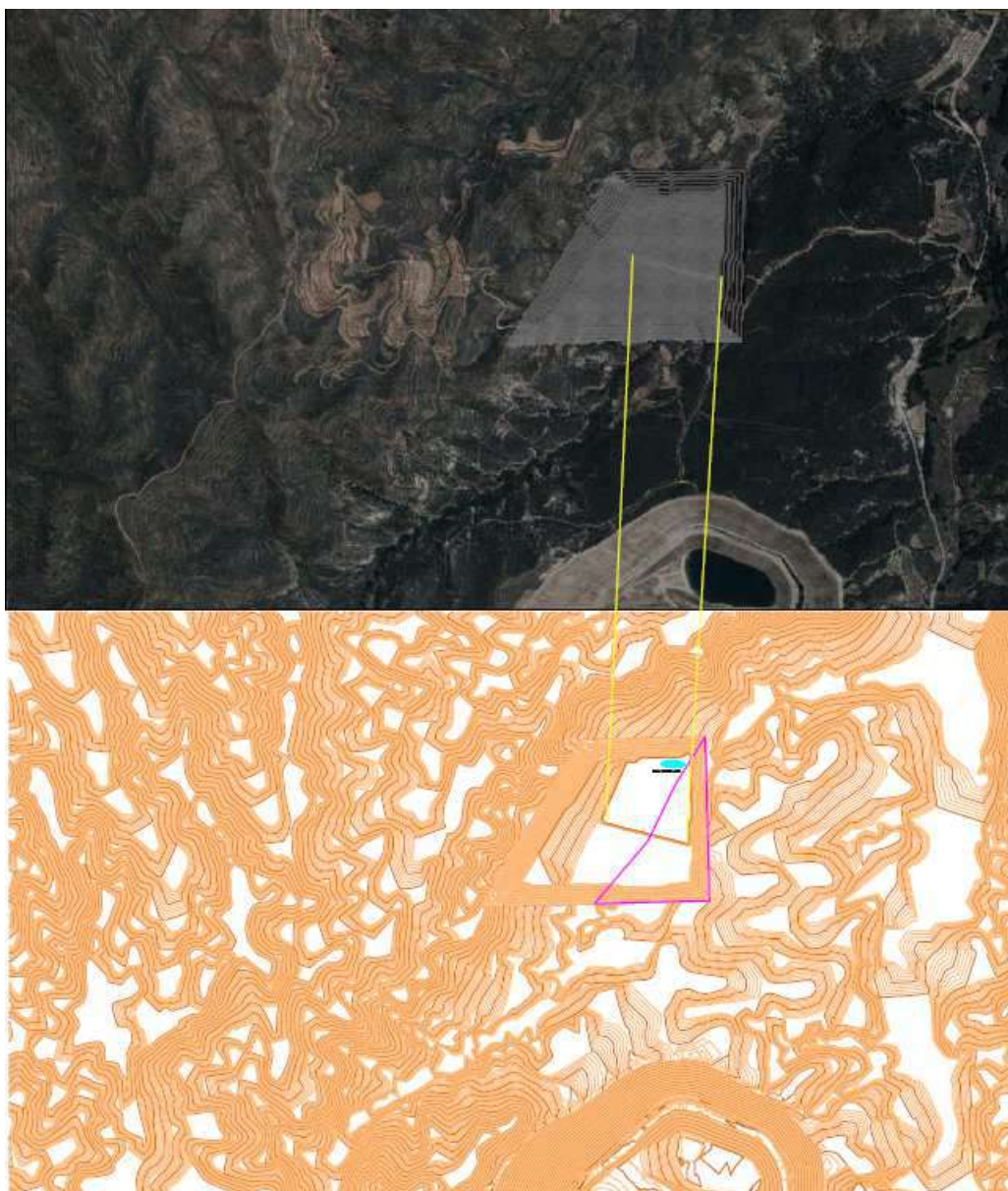
Figura 47. Simulación 3D y curvado de situación del hueco teórico de explotación tras la explotación de la Fase III (trama marrón en la simulación y perímetro en magenta en el curvado) y el resto del hueco teórico de explotación y sus correspondencias mediante líneas en amarillo con la simulación.
