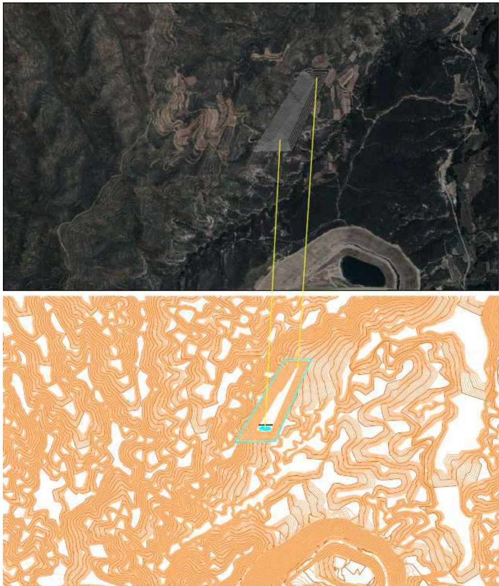
Figura 40. Simulación 3D y curvado de situación tras la explotación de la primera parte de la Fase I de explotación, donde se puede observar la creación del hueco de explotación (perímetro azul) y su correspondencia con la simulación mediante líneas amarillas. La trama en azul es la balsa de agua situada en el fondo de la corta.
